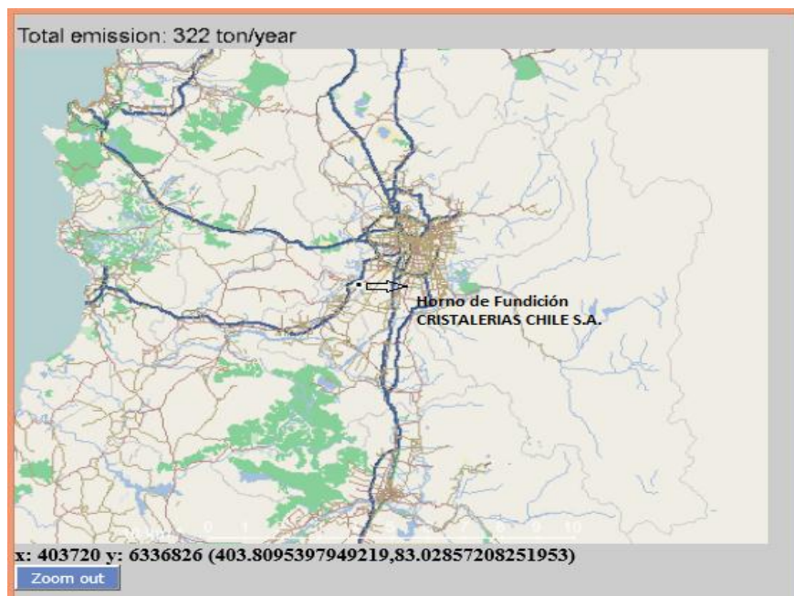
Figura 31 Mapa Región Metropolitana en plataforma Airviro correspondiente a la fuente puntual con Reg. Sesma 2263; Proceso de Horno de Fundición a Petróleo 6 con abatimiento de Precipitador electrostático con mayor emisión de \text{NO}_x correspondiente a CRISTALERIAS CHILE S.A.
