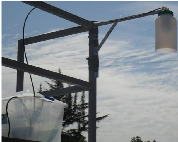
Figura 54: Fotografía del sistema FilterPack.
