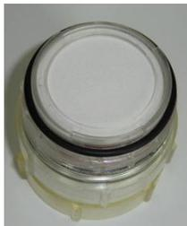
Figura 52: Fotografía de filtro impregnado para la colección de muestras atmosféricas.
